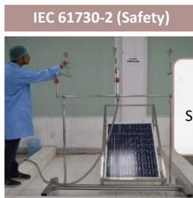
Module Breakage Test
